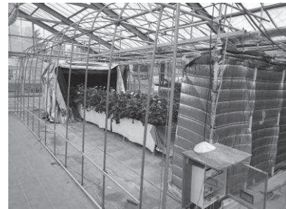
写真2 ナノファイバー多層断熱資材を展開した温室(試験2、3)
