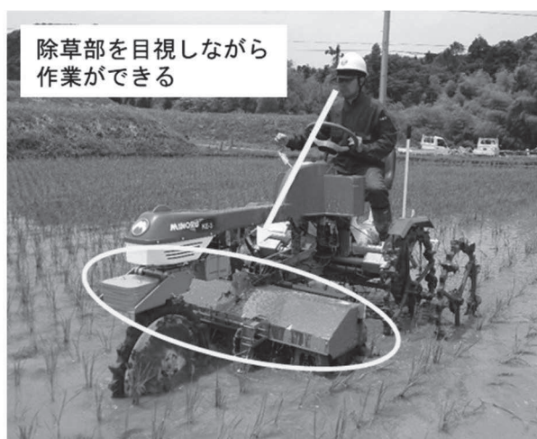
図－1 高効率水田用除草機による除草作業(左)と除草機構(右)
