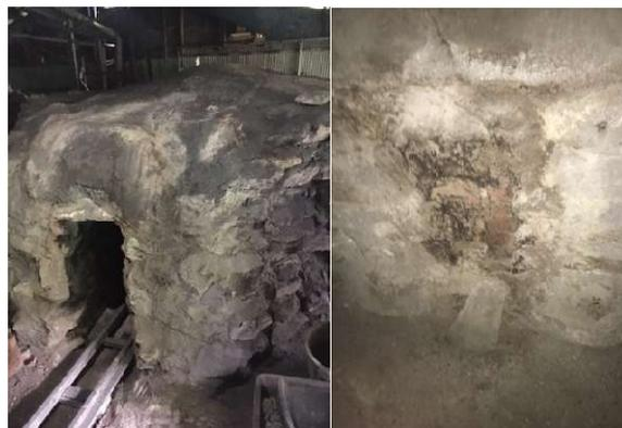
写真3左 土窯の入り口、写真3右 炭材を装填後無酸素炭化状態から冷却期間の入り口
