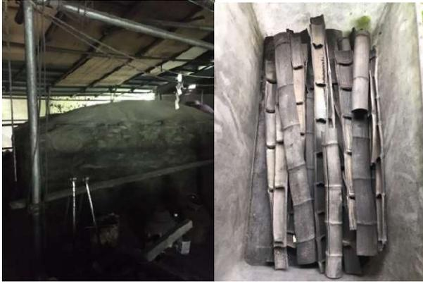
写真4左 冷却中の窯、写真右 搬出された竹炭
